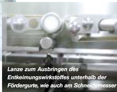
Maschineninnenraumentkeimung bei einem Längsfüller für Joghurt
