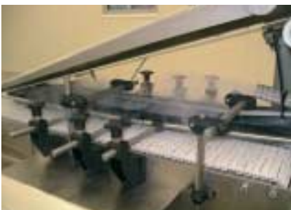
Abb. 1: Integrierte Packmittelvorentkeimung der Trays in einer Hackfleischlinie
