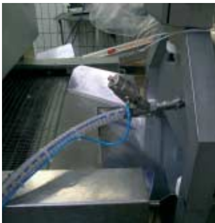
Abb. 3: Trommelschneider mit Wirkstoffaufschlagung
