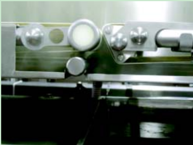
Lanze zum Ausbringen des Entkeimungswirkstoffs unterhalb der Fördergurte, wie auch am Schneidmesser Fotos: Air Solution GmbH, Bremen
