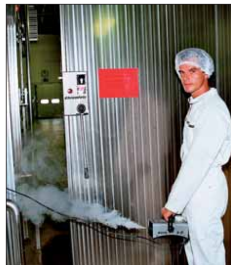
Robert Kuhl visualisiert mit einem Nebelgerät den Luftströmungsverlauf
